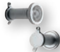
Türspion (nicht thermisch getrennt) Edelstahl matt, Ø 26 mm, Einfallswinkel 200°, Art.-Nr. 1318
